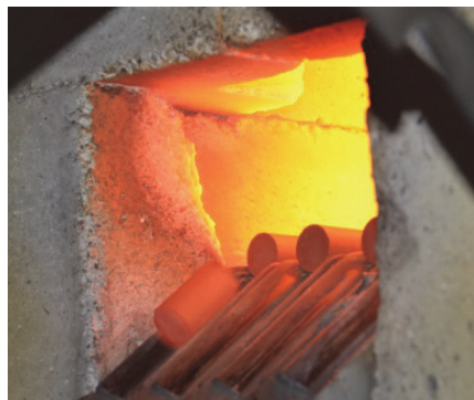
Uppvärmning av ämnen före smidning, en operation av flera som måste förändras vid en övergång till blyfria mäsingslegeringar.
