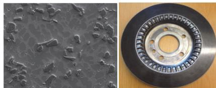
Metallografisk struktur för aktuell MMC, bestående av undereutektisk aluminiumlegering och partiklar av kiselkarbid, SiC (t.v.) och en komplett färdig bromsskiva i MMC (t.h.).
