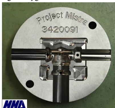
En verktygshalva för varmsmide av en mässingskuts till en elementventil.
