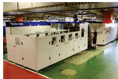
En ny s.k. ”bartransfer” maskin vid MMA som möjliggör en konkurrenskraftig tillverkning av komponenter i blyfri mässing bl.a. genom snabba omställningar mellan olika materialtyper.
