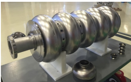
Exempel på en kavitet tillverkad i niob.
